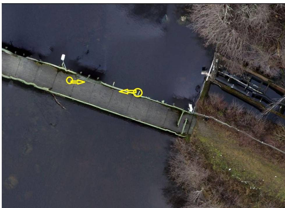
Figur 3. Placering av fiskräknarkamerorna IAMHYDROCam (till vänster) och TIVA (till höger) under bron vid Stora Åråsforsen 2025, markerade med gula cirklar. Foto: Länsstyrelsen i Västra Götaland.
