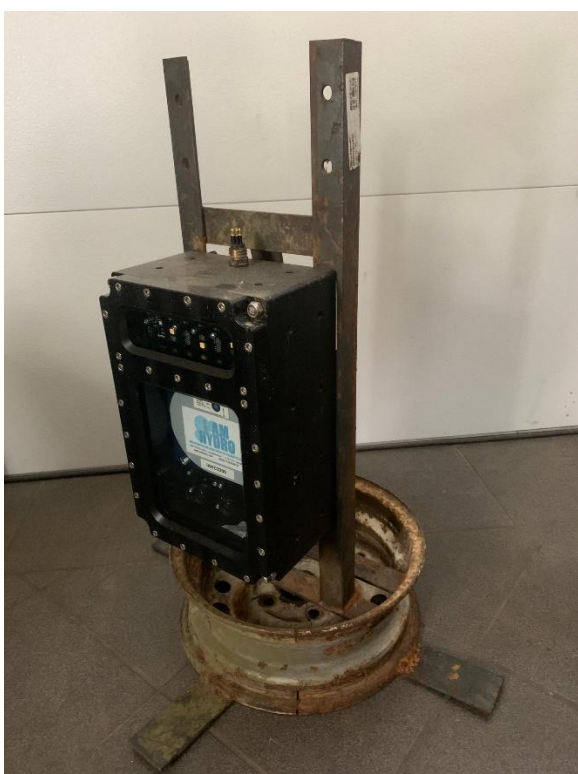
Figur 2. IAMHYDROCam med fäste som använts för övervakning i Gullspångsälven 2021-2025. Fälgen fylls även med sten. Foto: Fredrik Nilsson.
